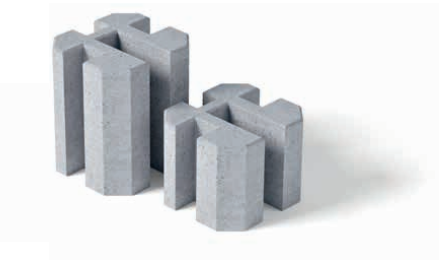
20 30 Łącznik czwórnik wys. 20 cm lub 30 cm dł. 36 cm szer. 24 cm
